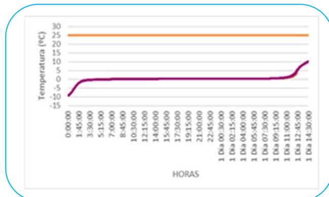
\*ENSAYOS REALIZADOS CON DOS ACUMULADORES REF. 900 EN CÁMARA CLIMÁTICA TEMPERATURA EXTERIOR CONSTANTE 25°C CON MATERIAL AISLANTE EPS 30mm ESPESOR
